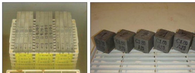
รูปที่ 10 การขยายตัวเนื่องจากโซเดียมซัลเฟตและการสูญเสียน้ำหนักเนื่องจากแมกนีเซียมซัลเฟต
