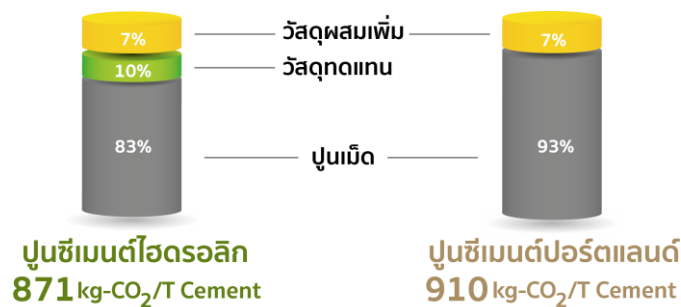
รูปที่ 1 เปรียบเทียบการลดการปล่อยก๊าซคาร์บอนไดออกไซด์ กรณีใช้วัสดุทดแทนที่ร้อยละ 10
